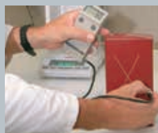
Mesure d'épaisseur de laque
