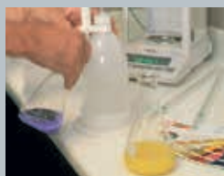
Contrôle des bains de traitement de surface
